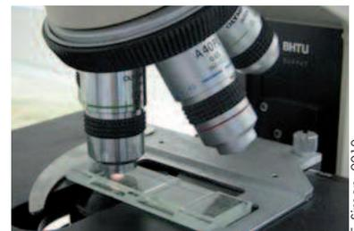
Photo 3 - Comptage des œufs d'helminthes au microscope avec une suspension de fientes dans une lame de McMaster.
